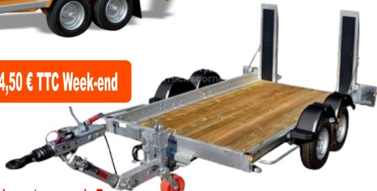
Ce matériel peut être transporté avec un véhicule avec attelage et un permis E
